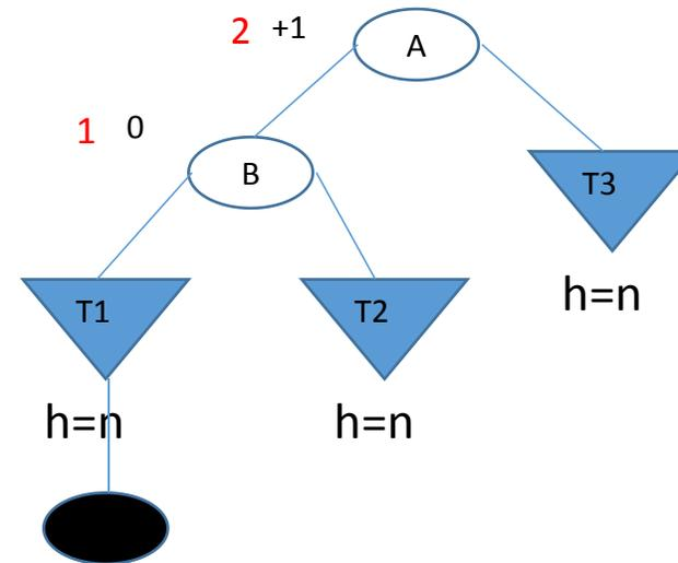
Cas 1 : Le nouveau nœud est inséré dans le sous arbre gauche de B. Donc  $f(B)$  devient 1 et  $f(A)$  devient 2
